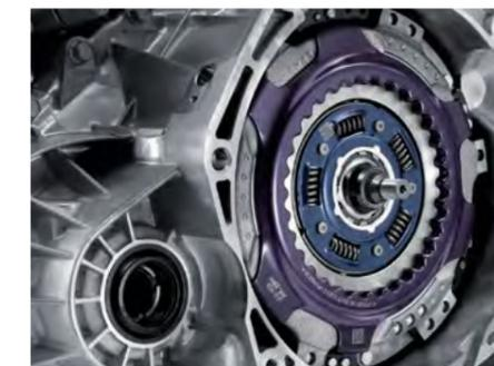
7-stupanjski automatizirani mjenjač s dvostrukom spojkom (DCT)
