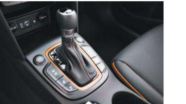
7-stupanjski mjenjač s dvostrukom spojkom (DCT)
