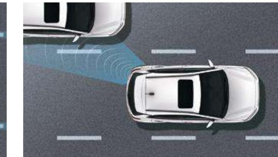
**Upozorenje na sudar s vozilom u mrtvom kutu (BCW)\* u kombinaciji sa sustavom pomoći za zadržavanje vozila u voznoj traci (LKA)**
